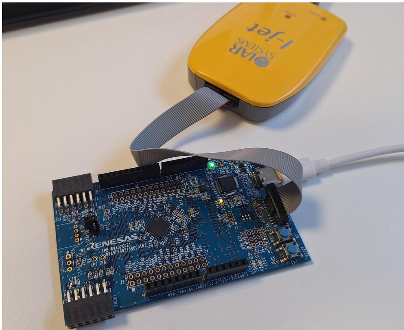
この評価ボード (FBP-R9A02G021) は、オンボード・デバッガも搭載していますが、外部のデバッガを接続するコネクタも搭載されています。
